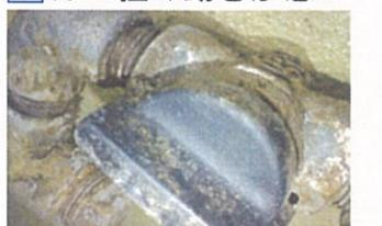
ガス栓や器具栓が劣化すると、すき間からガスが漏えいします。
