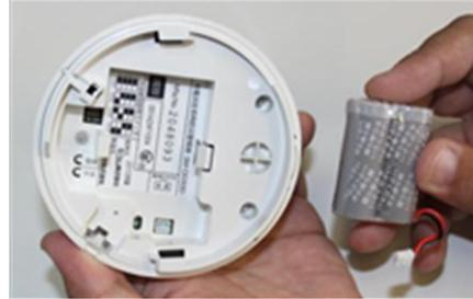
電池切れの時には音声でお知らせするか、ピッ・・・ピッ・・・と短い音が一定の間隔で鳴りますので、新しい電池若しくは新しい警報器に交換してください。
